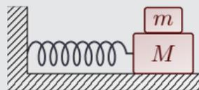
A un dato istante, un blocco di massa  $m < M$  viene piazzato sopra la massa  $M$ . È noto il coefficiente di attrito statico  $\mu_s$  tra i due blocchi. Si determini la massima ampiezza delle oscillazioni che può avere il sistema dei due blocchi sovrapposti senza che vi sia scivolamento di  $m$  rispetto a  $M$ .
