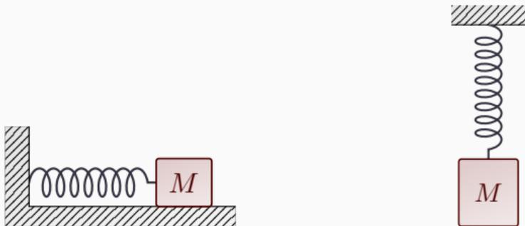
Se la massa  $M$  attaccata alla molla disposta orizzontalmente viene spostata di  $A$  dalla posizione di equilibrio, essa oscilla di moto armonico di ampiezza  $A$  e pulsazione  $\omega_0 = \sqrt{k/M}$  e un periodo  $T = 2\pi\sqrt{k/M}$ . Si può dire lo stesso per la medesima massa, attaccata alla stessa molla ma disposta verticalmente e spostata della medesima quantità  $A$  dalla posizione di equilibrio? Vedi esercizio 3...
