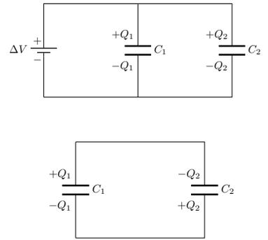
6. (a) Calcolare la capacità equivalente del circuito mostrato nella figura a lato. (b) Se  $C_1 = C_2 = 2C_3 = 24,0 \mu\text{F}$  e  $\Delta V = 35 \text{ V}$  quanta carica si accumula su ciascun condensatore?
