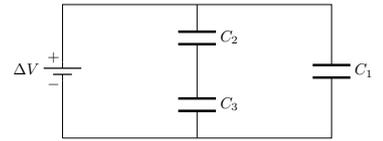
7. Se nel circuito in figura  $C_1 = C_2 = C_3 = 22,6 \mu\text{F}$  e  $\Delta V = 10 \text{ V}$  quanta energia è immagazzinata nella rete di condensatori?
