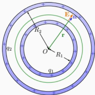
Se  $r \geq R_2$ , la carica elettrica all'interno della sfera è pari a  $q_1 + q_2$  e, sempre per la simmetria sferica della distribuzione di carica, il campo elettrico non può che essere diretto radialmente con valore costante sulla superficie; quindi:
