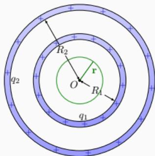
Se  $R_1 \leq r < R_2$ , la carica elettrica all'interno della sfera è pari a  $q_1$  e, data la simmetria della distribuzione di carica, il campo elettrico deve essere diretto radialmente con valore costante sulla superficie; quindi:
