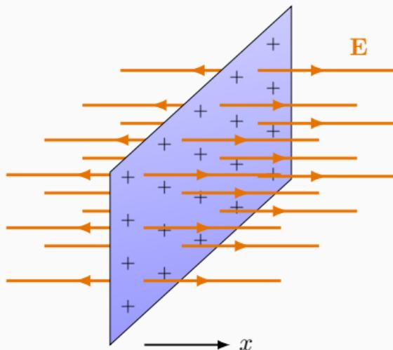
Una distribuzione piana infinitamente estesa con densità superficiale di carica  $\sigma$  genera un campo elettrico uniforme, di intensità  $E = \sigma/2\epsilon_0$  perpendicolare al piano, diretto in versi opposti nei due semispazi individuati dal piano (**II Lezione**).
