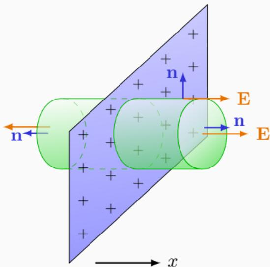
È questo il motivo per il quale la carica elettrica all'interno del cilindro è indipendente dalla lunghezza del cilindro, ma è funzione del raggio  $R$  delle basi del cilindro!!
