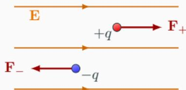
Per la seconda legge della dinamica,  $\mathbf{F} = m\mathbf{a}$ , la carica sarà sottoposta a un'accelerazione costante
