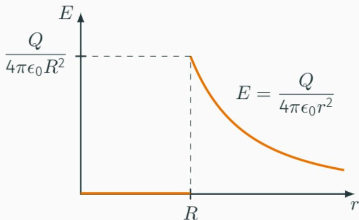
Anche per una **sfera metallica** di raggio  $R$  che possiede una carica  $Q$  si ha quest'andamento del campo elettrico poiché una carica  $Q$  data in eccesso a un conduttore si distribuirà sulla sua superficie!
