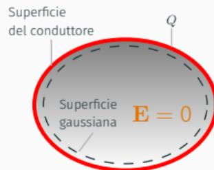
Prendendo come superficie gaussiana una superficie giacente immediatamente al di sotto della superficie esterna e che racchiuda l'intero volume del conduttore, il flusso di  $\mathbf{E}$  attraverso tale superficie è nullo. Per la legge di Gauss la carica netta all'interno di questa superficie è nulla: la quantità di carica  $Q$  data in eccesso deve essere sulla superficie del conduttore.
