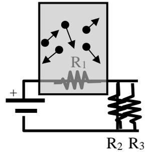
**3. Soluzione.** Il circuito elettrico può essere ricondotto ad un circuito semplificato formato da una sola maglia. Ciò si ottiene sostituendo alle resistenze  $R_2$  ed  $R_3$  la resistenza equivalente parallelo  $R_p=R_2//R_3$  che vale  $R_p = \frac{R_2 \cdot R_3}{R_2 + R_3} = 6\Omega$
