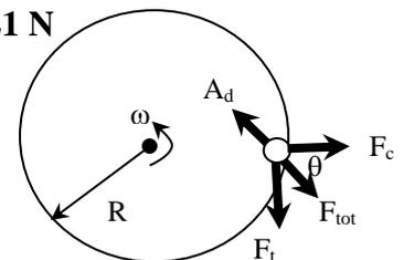
**inclinata rispetto alla radiale di un angolo**  $\theta = \arctan\left(\frac{F_t}{F_c}\right) = \arctan\left(\frac{\alpha}{\omega^2}\right) = 4.57^\circ = 4^\circ 34'$
