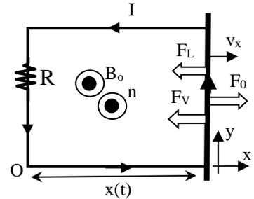
l'**intensità di corrente indotta** nel circuito  $I = \frac{f_i}{R} = -\frac{B_o L}{R} v_x$
