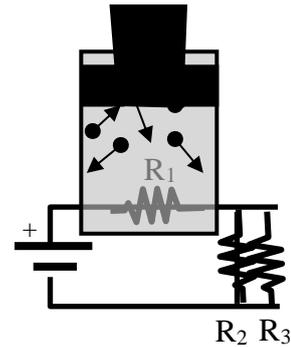
**3. Soluzione.** Il circuito elettrico può essere ricondotto ad un circuito semplificato formato da una sola maglia. Ciò si ottiene sostituendo alle resistenze  $R_2$  ed  $R_3$  la resistenza equivalente parallelo  $R_p=R_2//R_3$  che vale  $R_p = \frac{R_2 \cdot R_3}{R_2 + R_3} = 3\ \Omega$
