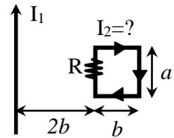
2. Una spira rigida quadrata di lato  $a$  e di resistenza elettrica  $R$  si muove nel vuoto su di un piano contenente un lungo filo rettilineo percorso dalla corrente  $I$ , con velocità costante  $v$ , mantenendo uno dei suoi lati parallelo al filo stesso. Ricavare in funzione della distanza  $L(t)$  l'espressione della forza esterna che occorre applicare alla spira per mantenere costante la velocità di traslazione.
