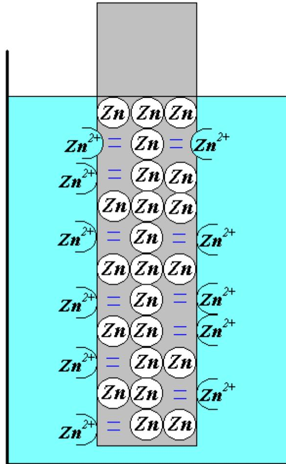
Gli atomi di zinco passano in soluzione come ioni  $Zn^{2+}$  idrati:  $Zn \rightarrow Zn^{2+}_{aq} + 2e^-$ ; gli elettroni restano nel metallo e si crea un doppio strato elettrico fra l'elettrodo (carico negativamente per l'eccesso di elettroni) e la soluzione (carica positivamente per la presenza degli ioni  $Zn^{2+}$ ).
