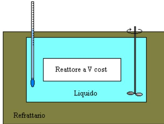
Grammi 1.85 di carbonio (grafite) vengono bruciati con eccesso di ossigeno in un contenitore di acciaio perfettamente chiuso (Bomba calorimetrica) di massa 2.835 kg, immerso in un recipiente perfettamente isolato contenente 3.200 kg di acqua. Un termometro immerso nell'acqua indica, dopo la reazione di combustione, un aumento di temperatura di 4.12 °C.
