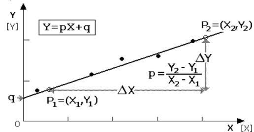
In laboratorio l'elaborazione statistica delle  $N$  coppie di misure verrà effettuata tramite il **metodo dei minimi quadrati** che consiste nel determinare i parametri che minimizzano globalmente le distanze (al quadrato) dei punti sperimentali dalla retta
