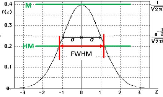
Anche la distribuzione delle **media aritmetica** (norma) di N misure tende, al crescere di N, a una gaussiana (teorema del limite centrale)
